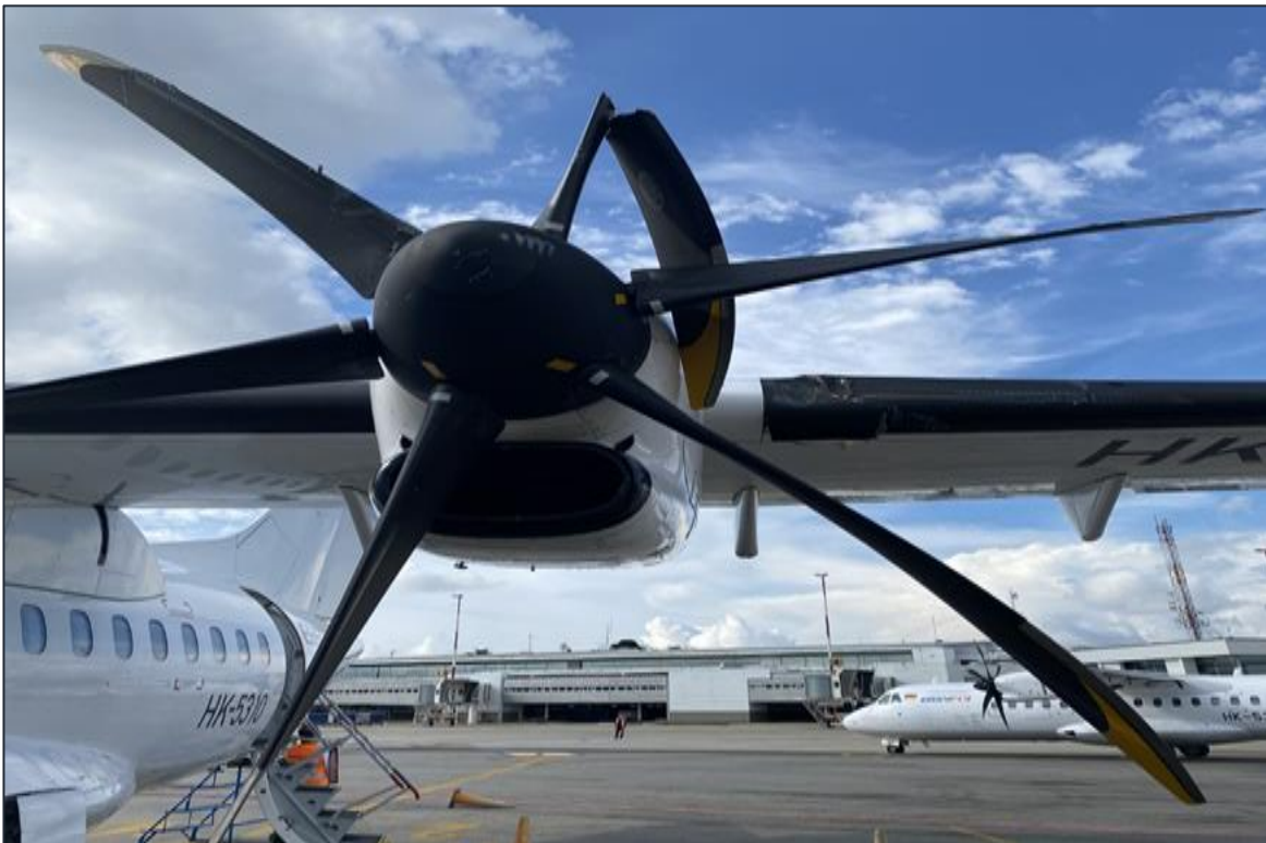
Fotografía No. 1: daños en la hélice del motor izquierdo del HK 5310
